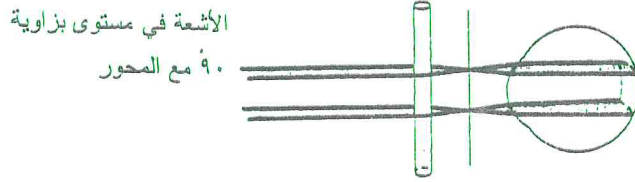
شكل ٦-٦: بصريات قضيب مادوكس. يرد الضوء على محور معامد لمحور قضيب مادوكس.
